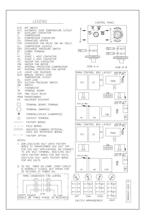
FIGURE 15 - COMPONENT ARRANGEMENT - 90MA/MU008/012
